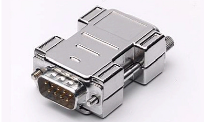
Obr. 4.4 Obojsmerný konvertor RS-232 / RS-422 určený na predĺženie dosahu RS-232
