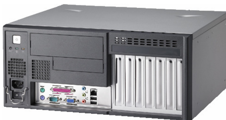
Obr. 4.50 Šasi priemyselného počítača IPC-7120 pre matičné dosky ATX
