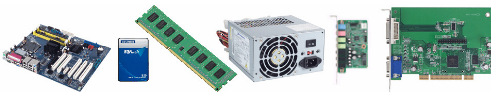
Obr. 4.48 Časti priemyselného počítača: matičná doska, pamäťový modul (pevný disk), RAM, zdroj, zvuková a grafická karta
