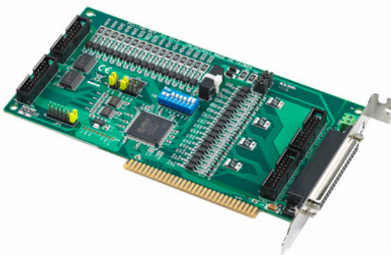
Obr. 4.55 Karta určená pre získavanie dát a riadenie (laboratórna karta) PCL-730 s konektorom ISA
