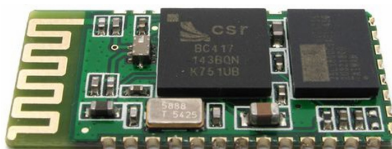
Obr. 4.8 Bluetooth modul HC-05, špecifikácia Bluetooth 2.0
