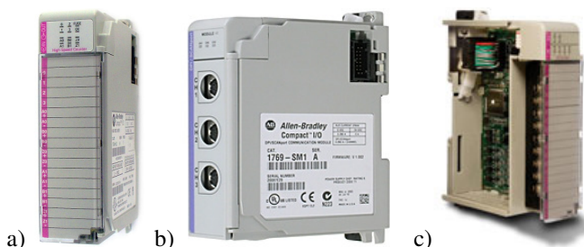
Obr. 4.42 Špeciálne karty pre PLC rady CompactLogix, a)HSC , b)SM-1, c)BOOLEAN
