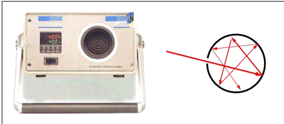
Obr. 19 Provedení a princip černého zářiče [11]
