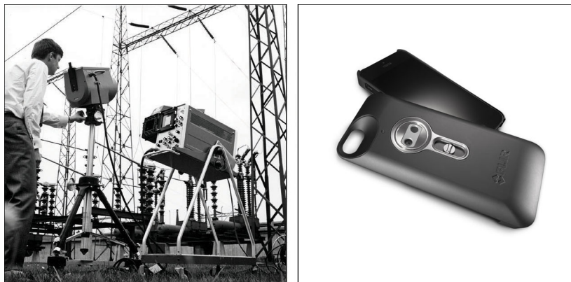
Obrázek 14.2 VLEVO: Thermovision Model 661 z roku 1969. Kamera vážila přibližně 25 kg, osciloskop 20 kg a stativ 15 kg. Obsluha také potřebovala generátor 220 V AC a 10litrovou nádobu s tekutým dusíkem. Vlevo od osciloskopu je vidět nástavec Polaroid (6 kg). VPRAVO: Model FLIR One, který byl uvedený na trh v lednu 2014, je příslušenství, které se nasune na telefon iPhone a poskytne mu funkce teplotního zobrazování. Hmotnost: 90 g.
