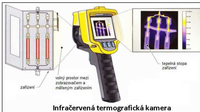
Obr. 16 Použití infračervené termografické kamery [5]
