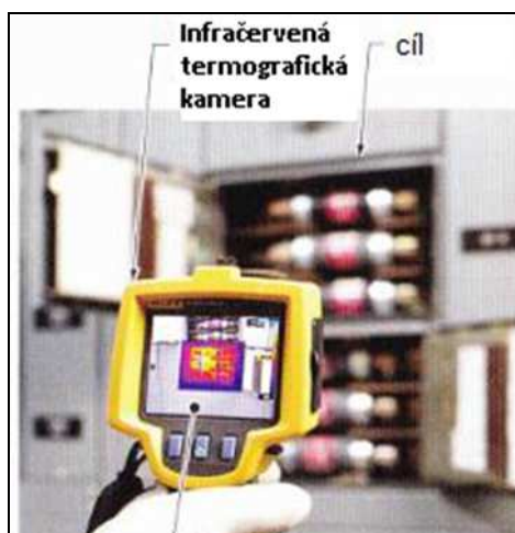
Obr. 17 Použití infračervené termografické kamery [5]
