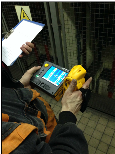
Obr. 43 Měření infračervenou termografickou kamerou FLUKE Ti45
