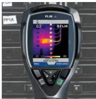
Termokamera FLIR i3 měří teplotu v 3600 bodech najednou
