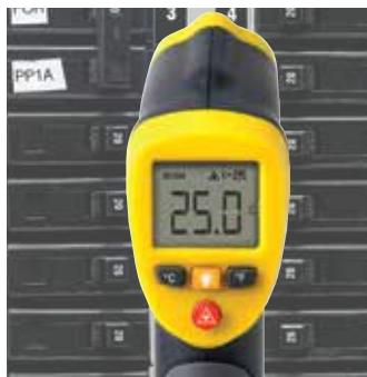
IR teploměr měří teplotu v jednom bodě
