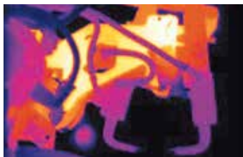
Horké místo ve svařovacím robotu
