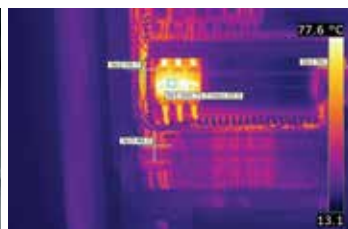
Pojistky zobrazené na obrazovce termokamery jsou přetíženy a je třeba je vyměnit.
