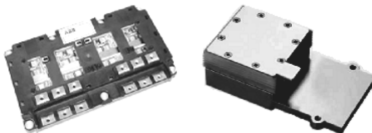
Obr. 4.5 Vľavo: IGBT tranzistor 2500V/1200 ako jeden spínací prvok, vpravo: IGBT modul (obsahuje 6 spínacích prvkov) 2500V/700A
