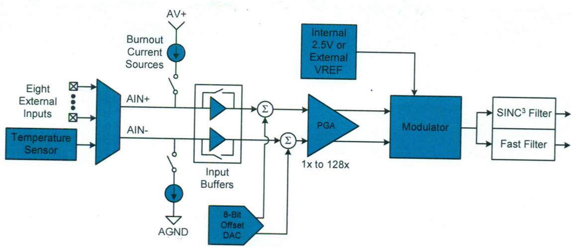
Figure 1.7. ADC0 Block Diagram
