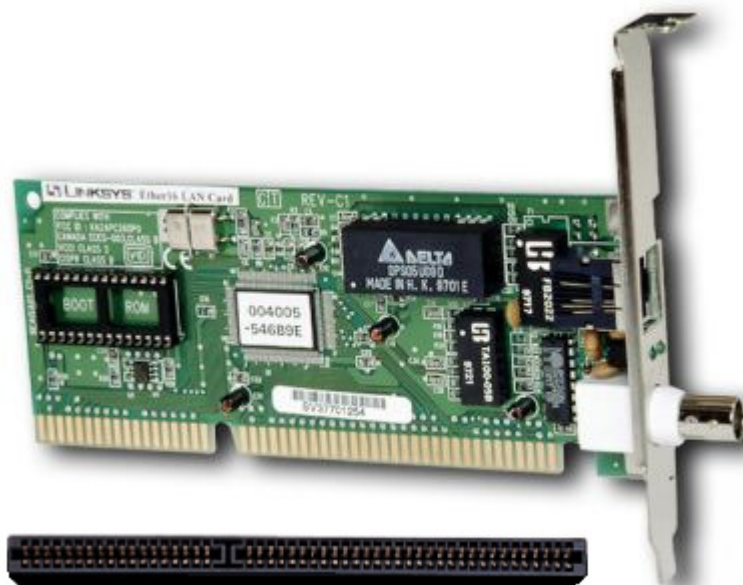
Obr. 3.9 Sieťová karta pre zbernicu ISA (hore) so slotom zbernice ISA (dole)
