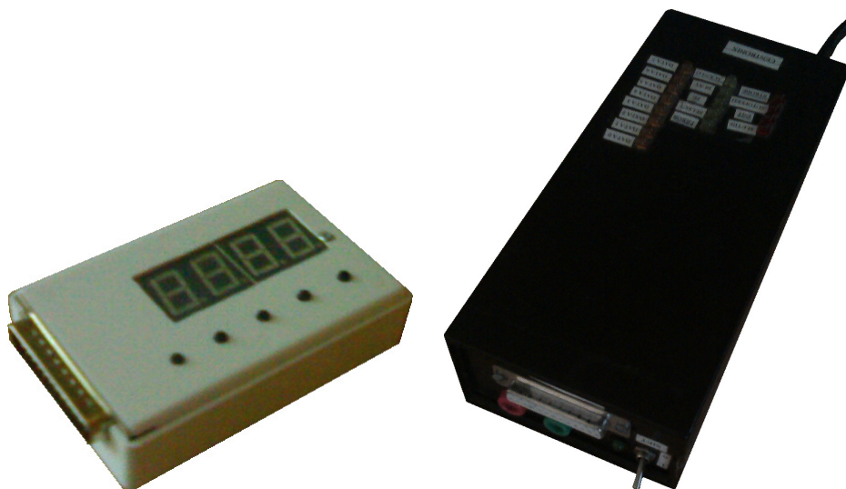
Obr. 7.29 Laboratórne prípravky pre prácu s rozhraním Centronics
