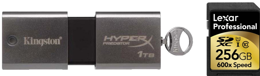
Obr. 1.23 Flash pamäte (z ľavej strany do pravej: USB kľúč, pamäťová karta SD)
