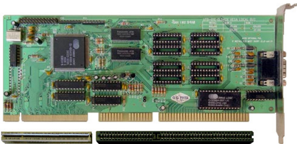
Obr. 3.13 Grafická karta pre zbernicu VL BUS (hore) a slot zbernice VL BUS (dole)
