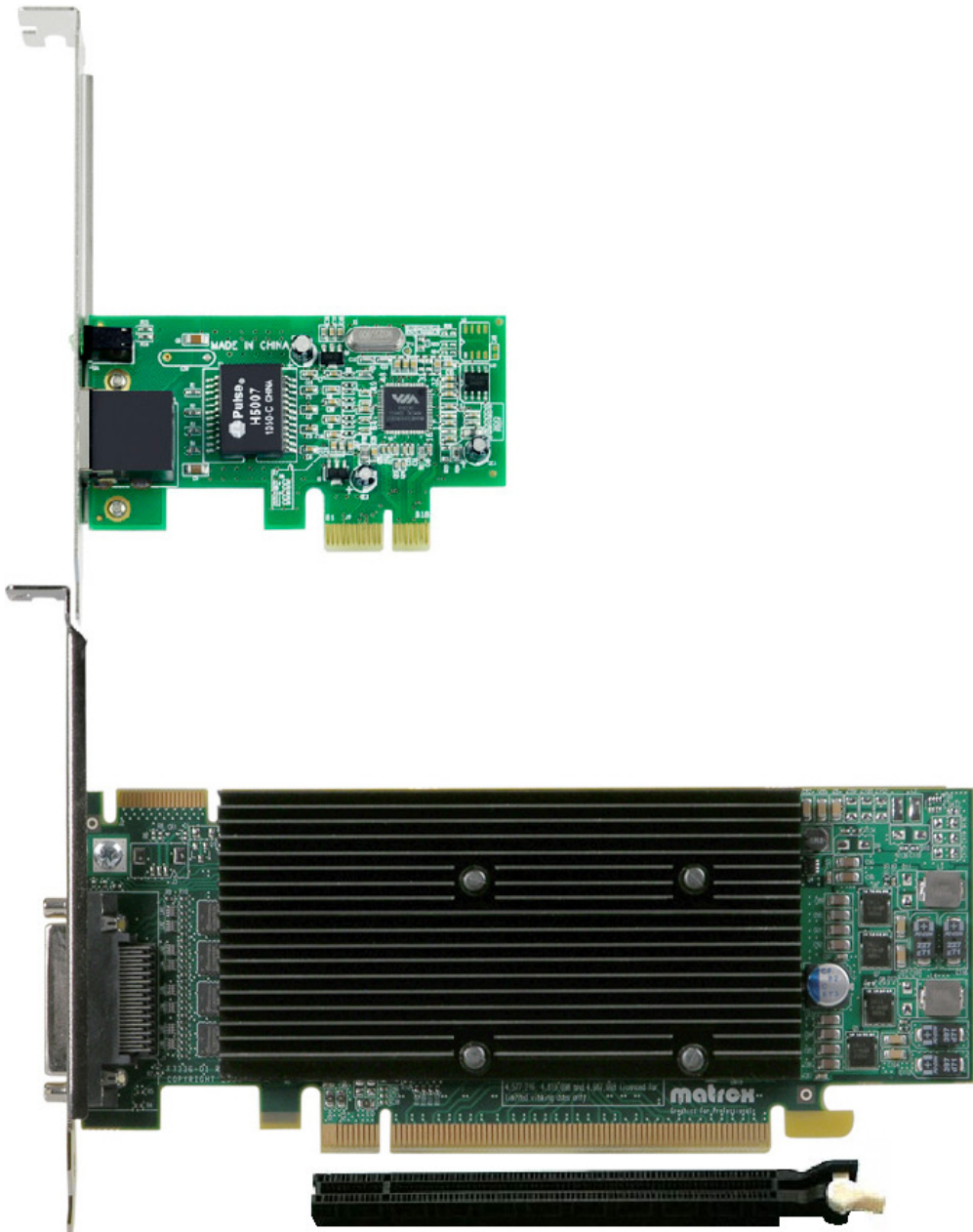
Obr. 3.27 Rozširujúce karty s konektormi PCIe x1, PCIe x16 a slot PCIe x16 (zhora nadol)
