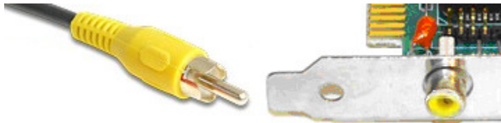
Obr. 2.34 RCA káble a koncovky grafickej karty
