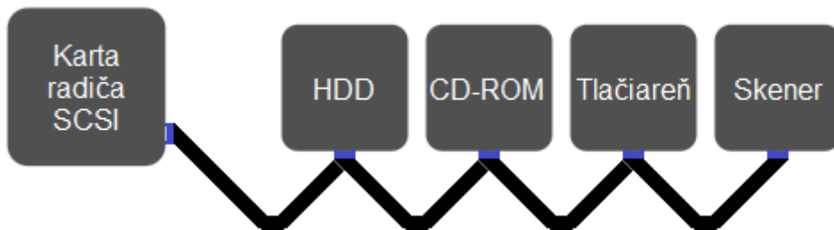
Obr. 3.36 Pripojenie periférií k radiču SCSI
