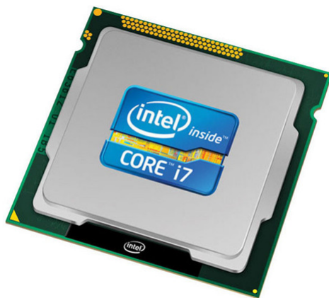
Obr. 1.11 Prvková základňa procesora počítačov 4. generácie (procesor Intel Core i7 tranzistor dosahuje veľkosť 14 nm k roku 2014)
