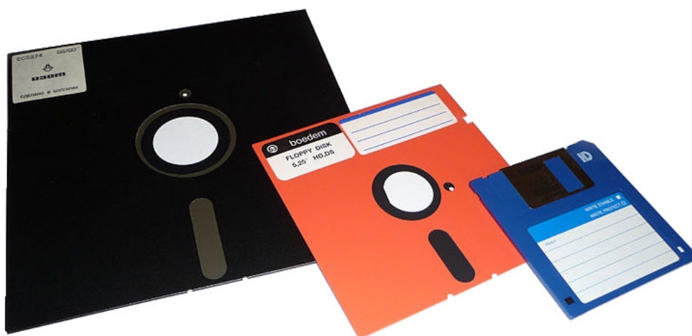
Obr. 1.21 Diskety (z ľavej strany do pravej: 8", 5,25" a 3,5" disketa)
