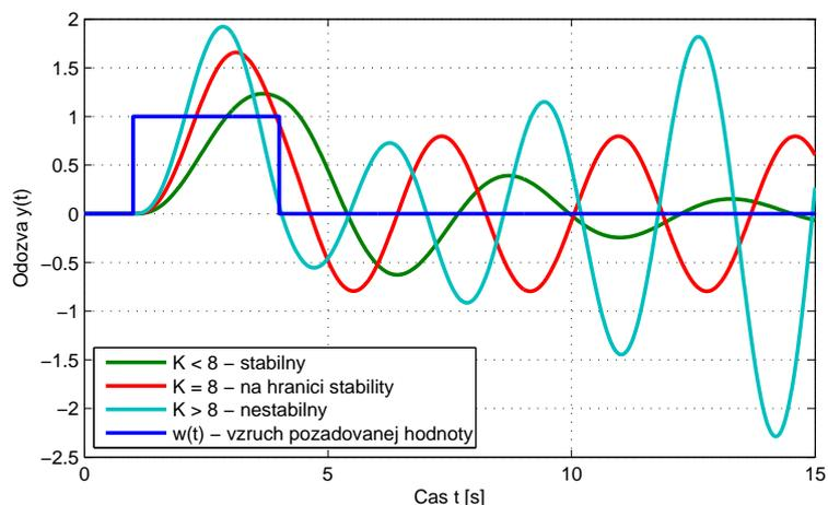
**Zadanie:** Pomocou Hurwitzovho kritéria vyšetrite stabilitu uzavretého regulačného obvodu podľa obrázku a následne určte kritické zosilnenie P-regulátora, ak na vzruch použijete zmenu poruchového signálu  $z(t)$
